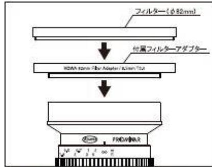
・レンズ先端に付属のフィルターアダプターを取付けることで、 $\phi$ 82mm のフィルターを取付け可能です。
