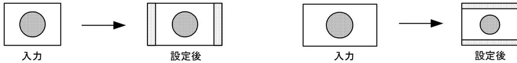
“ドットバイドット” 設定時 → ドットバイドットで出力します。出力解像度が入力解像度より小さい場合は、“固定” 設定と同じ動作となります。
