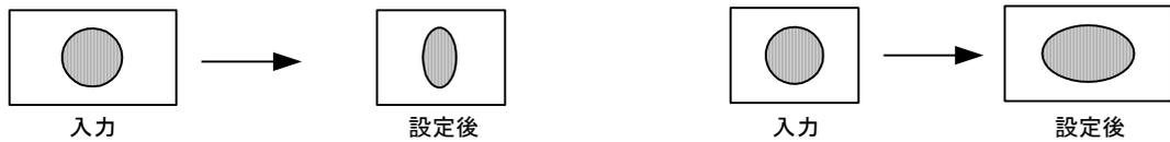
“固定” 設定時 → 入力映像のアスペクト比を保ったまま、できるだけ大きく出力します。
