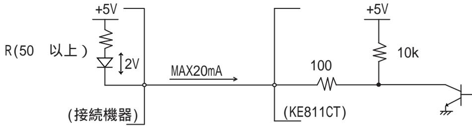
(例) 図のようにLED (順電圧 2V) を付ける場合
