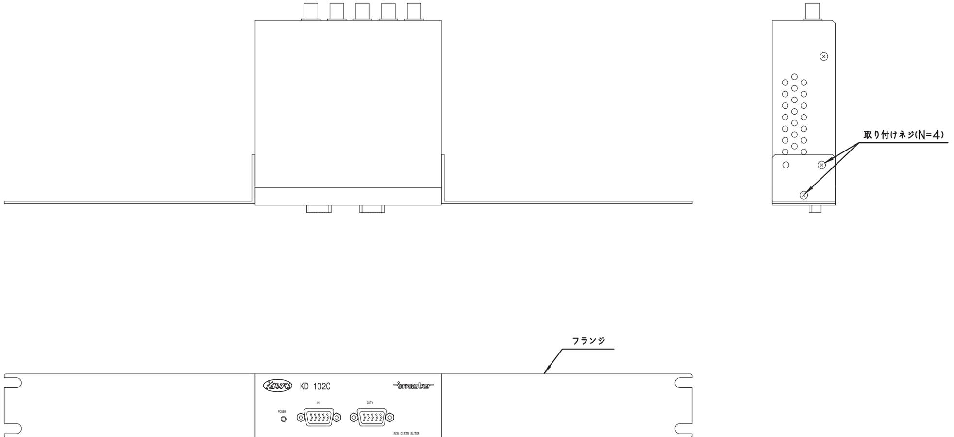
1. KD 102Cのカバー取り付けネジ(両側のネジ4本)を外す。
